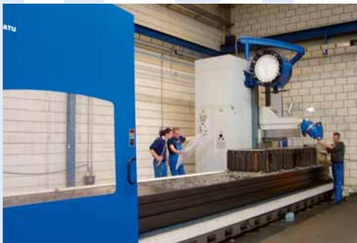
Höchstwahrscheinlich die größte Metallbearbeitungsanlage in der Branche. Das größtmögliche zu bearbeitende Werkstück kann bis zu 8 x 2,2 x 1,4 Meter messen.
