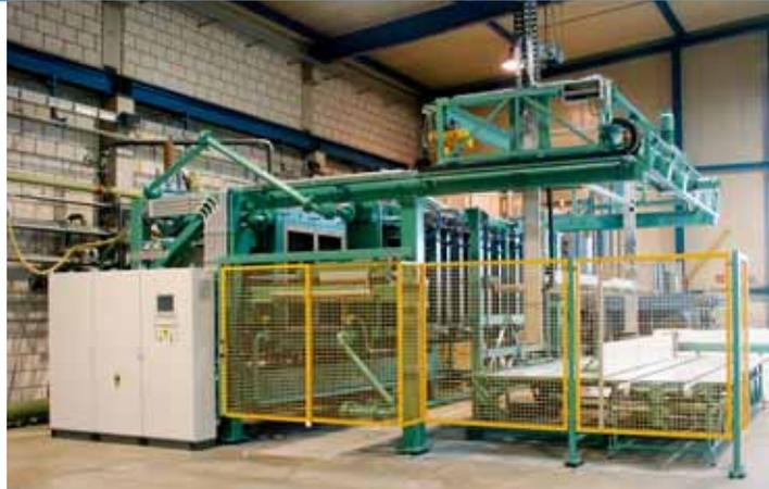
Sechs Perimeterplatten je Zyklus waren vom Kunden angefragt. Entsprechend entwickelte und baute Heitz die Maschine zur höchsten Zufriedenheit des Kunden.
