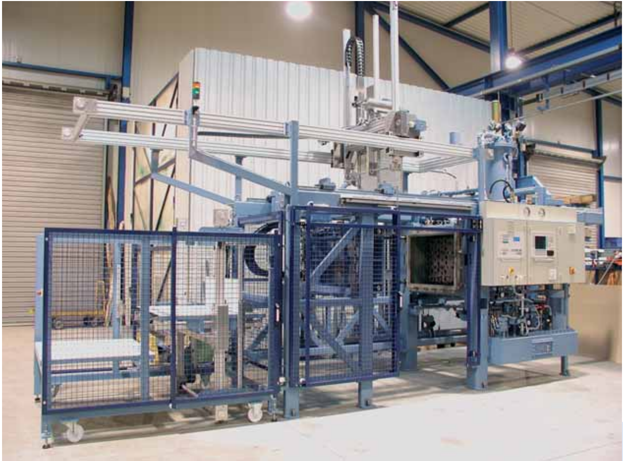
Abbildung: HEITZ HOZ 906 mit Handling-Roboter und Stapeltisch
