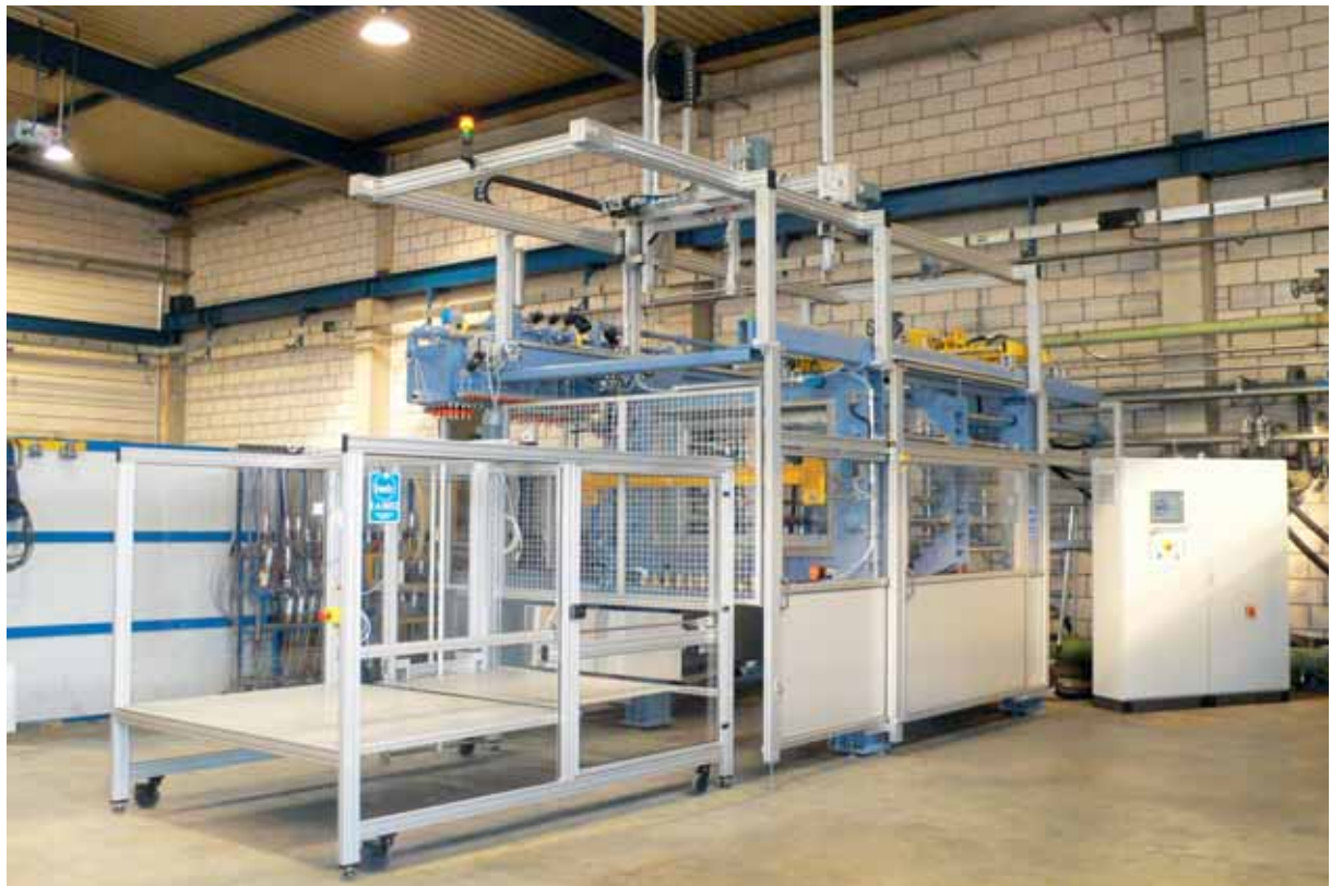
Abbildung: HEITZ HS 1309 INCENTIVE mit Handling-Roboter und Stapeltisch
